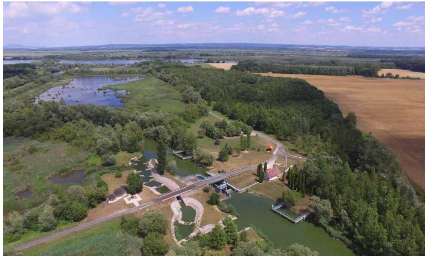
A Kis-Balaton vízvédelmi rendszere: vízszinttartó műtárgy hallépcsővel
